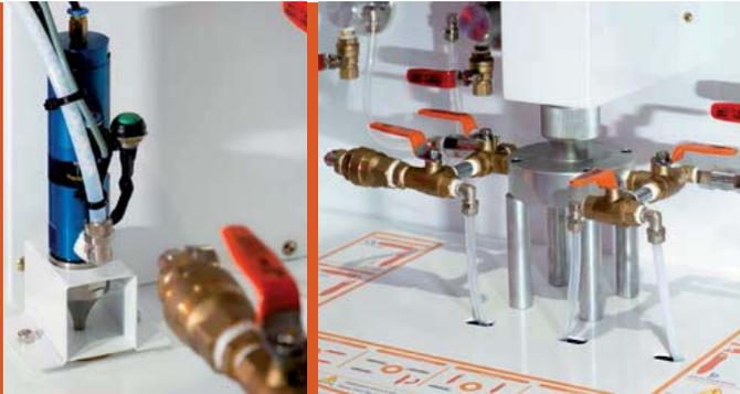
Cette nouvelle machine permet de déposer une fine couche de résine colorée en offrant un effet « doming ». Associée aux profils Domino sign, elle permet une utilisation sans soudure, ni peinture avec un gain de productivité important !
