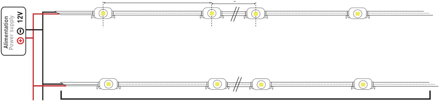
máximo 50 módulos en serie - 50 modules max in serial
